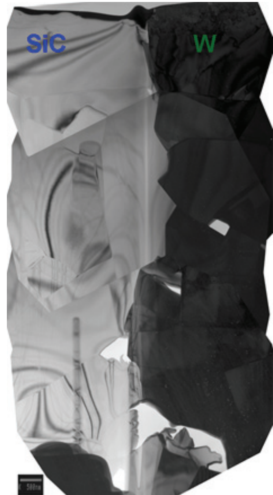
図 2-3. \alpha -SiC と W の接合界面
