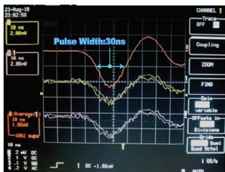
図 1. AlGaAs 超格子フォトカソードにより発生した電子ビームのパルス幅
