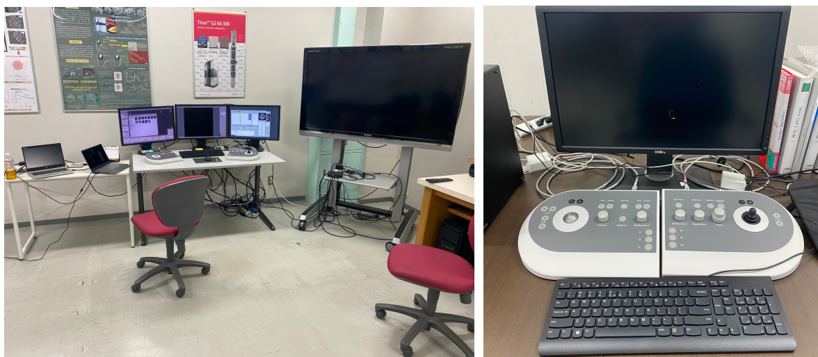
図 1. 光ケーブル通信の収差補正 STEM の操作室 (左)、遠隔操作可搬操作パネル (右)
